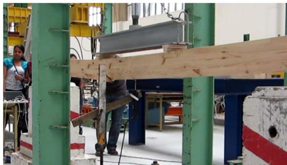
*Instante en el que se produce el colapso de la viga de madera laminada*
